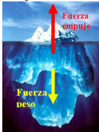
La figura muestra un iceberg. Aquí la fuerza empuje es mayor que el peso, por eso el iceberg flota.
